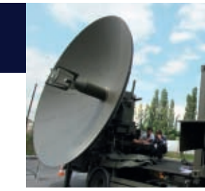
Station mobile de transmission par satellite
